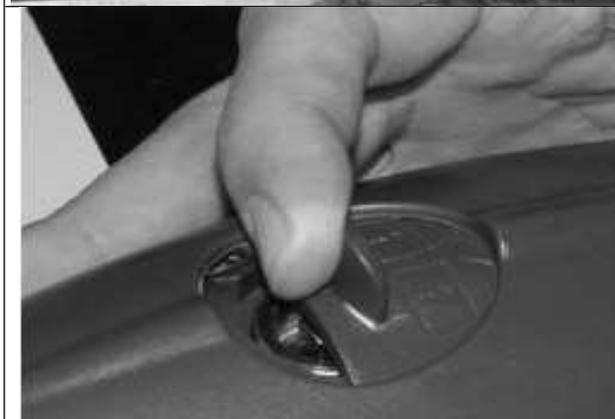
Faire glisser le couvercle, insérer la clé (accrochée au grillage à droite) dans l'ouverture et tourner dans le sens des aiguilles d'une montre.
